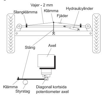
Vid hjulstyrning måste potentiometern monteras med ett fäste på axeln. Stången måste kopplas till en rörlig del som visar vinkeln på hjulen och som rör sig med hjulen. Krafter i andra riktningar har ingen verkan på potentiometern. Det är mycket viktigt att stången visar till märkt sida av potentiometern. Diagonal kortsida av potentiometers axel måste vara vänd mot stången.
