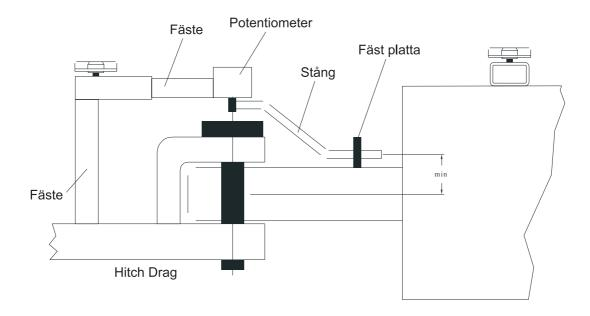
Fästet med låsskruven skall kortas av och svetsas på hitchen. Axeln på potentiometer skall vara centrerad över bulten. Korta fästet så mycket som behövs. Fäst fast fästet på potentiometern med låsskruven.
