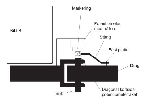
Monteringsprincipen vid styrning av styrbart drag visas i bild B. Potentiometern är monterad på redskapet med ett fäste.
