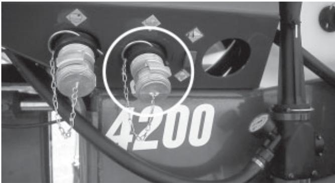
Le raccord rapide s'utilise ainsi, prise de force à l'arrêt :
