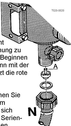
Zur Reinigung des Filters entfernen Sie Schlauch N und den Schlauch am Sicherheitsventil. Prüfen Sie, ob sich dort noch Rückstände befinden. Serienmäßige Filtergröße ist 80 Maschen. Filter mit 50 oder 100 Maschen sind ebenfalls erhältlich. Zum Ausbau des Filters lösen Sie die große Ringmutter.
