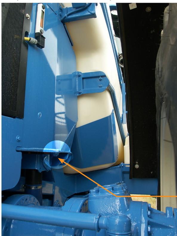
*Bouchon de vidange d'huile hydraulique*
