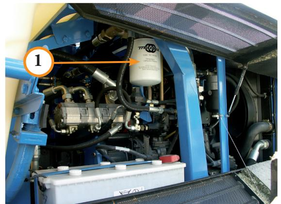
Les cartouches filtrantes peuvent être changées avant ces intervalles si le témoin indicateur de colmatage situé sur le corps du filtre devient rouge ②.
