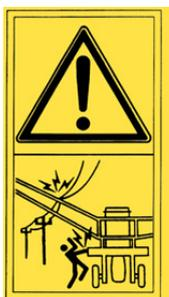
Avant toutes manœuvres de rampe, s'assurer qu'aucune personne ne se trouve dans les environs immédiats de la machine, que l'appareil ne soit pas sous une ligne électrique, qu'il n'y a pas d'obstacle. Le dépliage/repliage se fait automoteur à l'arrêt.
