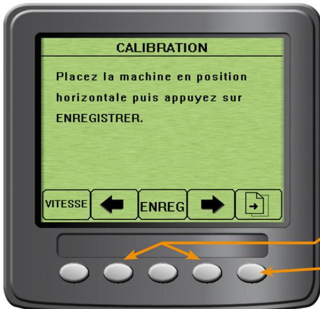
Ces 2 opérations doivent être réalisées lors du changement du capteur d'inclinaison (sur le pont arrière) ou pour reprogrammer les valeurs du capteur.
