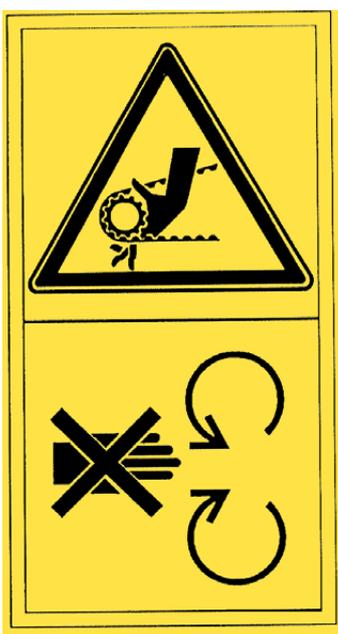
Attention aux courroies et poulies en mouvement. Ne pas ouvrir ou enlever les protections pendant que le moteur tourne.
