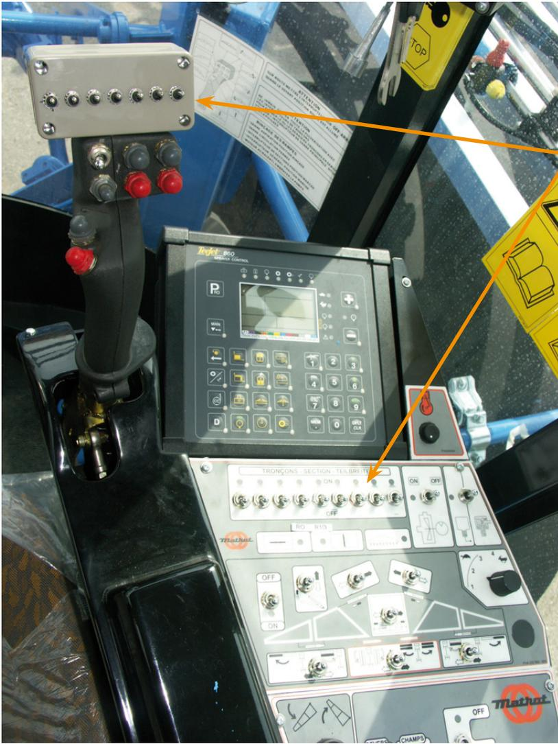
Pour piloter les coupures de tronçons à la poignée, les sélecteurs doivent être coupés (positionnés vers le bas) au niveau du pupitre. Pour les piloter depuis le pupitre, il faut donc les couper à la poignée.
