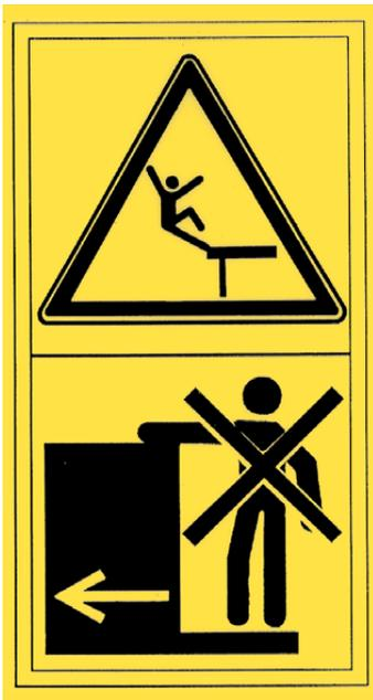
Quand la machine est en mouvement, il est interdit à toute personne de stationner sur les plateformes et/ou les échelles.
