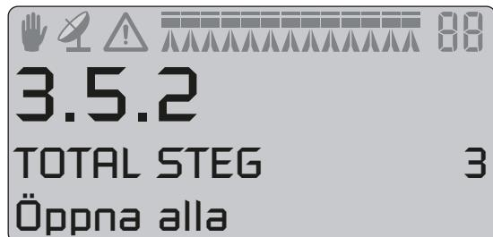
4.Öppna alla rampsektioner och töm tanken. Pulserna från flödesmätaren lagras i datorn. Under kalibreringen visar displayen: [xxx], för den aktuella vätskenivån i millimeter och [yyyyyyy], är antalet pulser från flödesmätaren.
