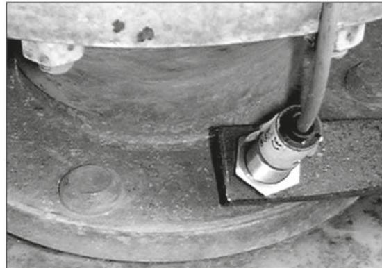
Det behövs en hastighet/kontakt kabelsätt (A) och en förlängningskabel för att koppla hastighetsgivaren och displayen.
